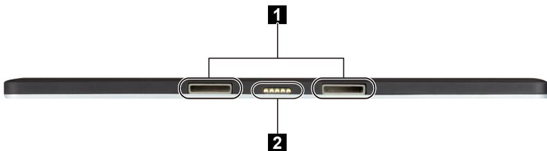
**1** Фиксатор планшетного ПК на клавиатуре
